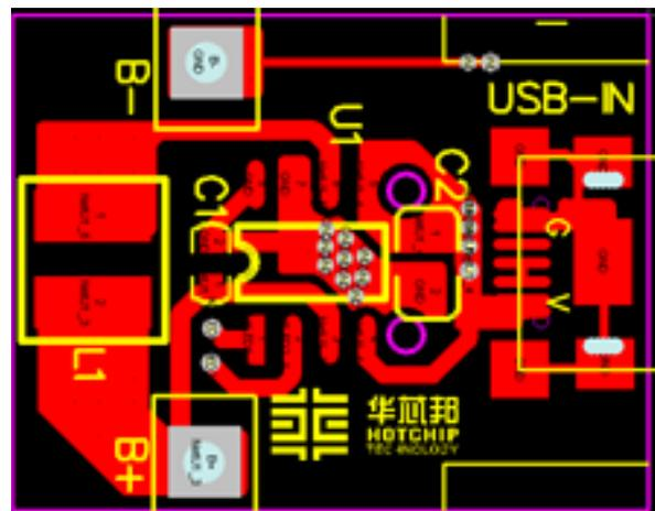
C1, C2 要紧靠芯片 2mm 以内，并且到芯片管脚的走线尽量短；为防止 L1 的热量影响芯片，L1 可稍远点在 5-10mm 左右，用粗线连接
